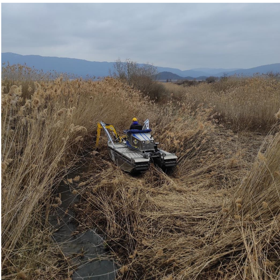
Εικόνες 3 & 4 . Δημιουργία αντιτυρικής ζώνης με χρήση του αμφίβιου μηχανήματος (φωτ. Λ.Νικολάου)
