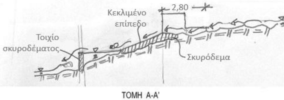
Σχήμα 4.2.21 Σκαριφηματική διάταξη έργων υδροληψίας ποταμού Αγίου Γερμανού.
