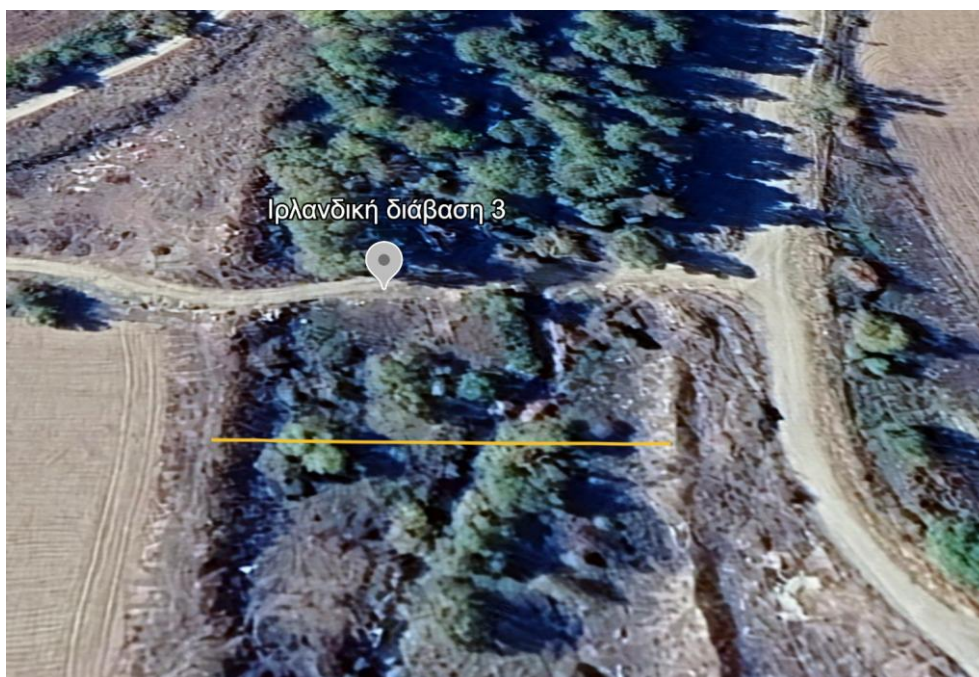
Σχήμα 4.2.16 Άποψη περιοχής ιρλανδικής διάβασης 3. Θέα προς κατάντη. Το μήκος της διάβασης (σημειώνεται με κίτρινη γραμμή) ανέρχεται σε 52 m. Η διάβαση φαίνεται να αποτελεί όριο μεταβολής της πυκνότητας της βλάστησης.
